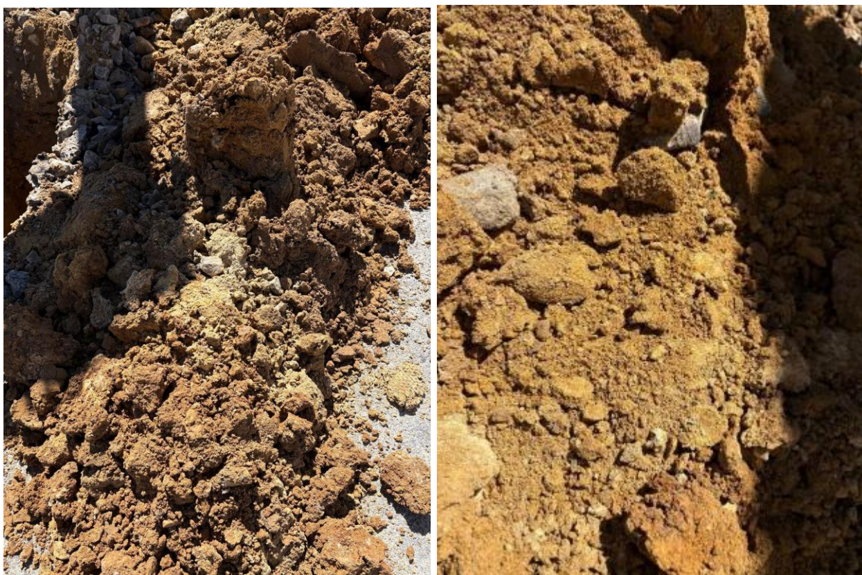
Figura 7-Material intersetado no horizonte de alteração de xisto grauvacóide – P04.
