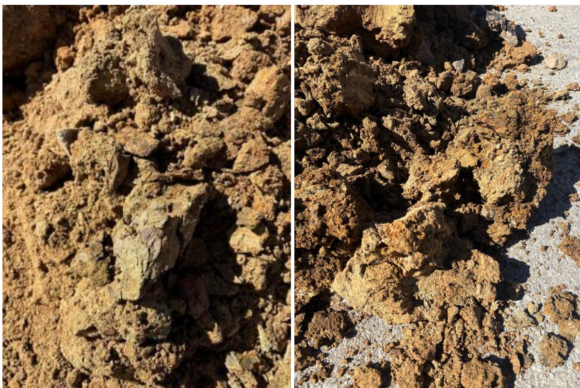
Figura 4-Material intersetado no horizonte de alteração de xisto grauvacóide – P01.
