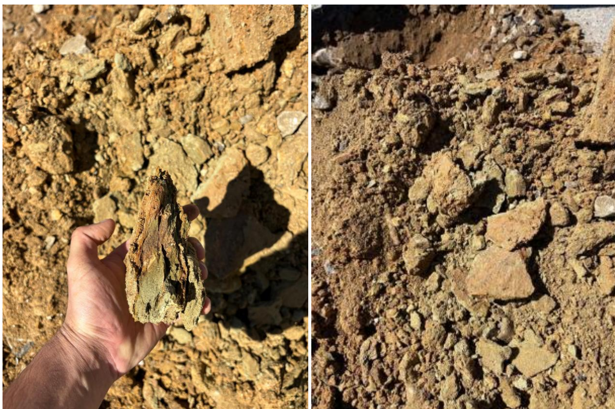
Figura 5-Material intersetado no horizonte de alteração de xisto grauvacóide, com clasto exemplificativo – P02.
