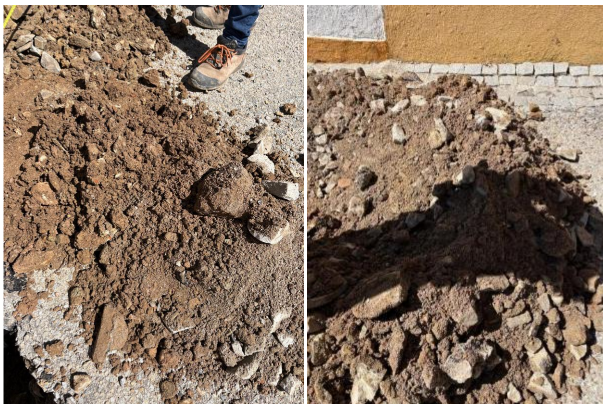
Figura 8- Material intersetado no horizonte de alteração de xisto – P05.
