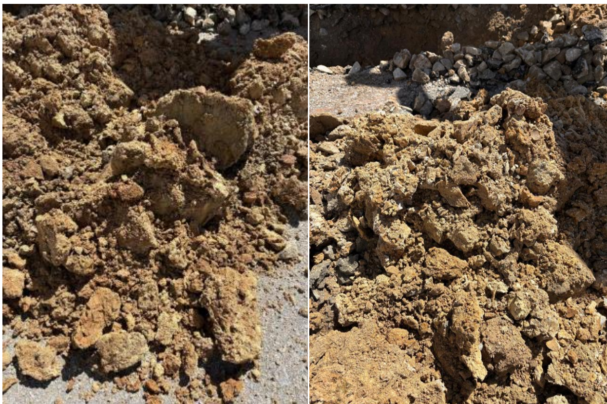
Figura 6-Material intersetado no horizonte de alteração de xisto grauvacóide – P03.
