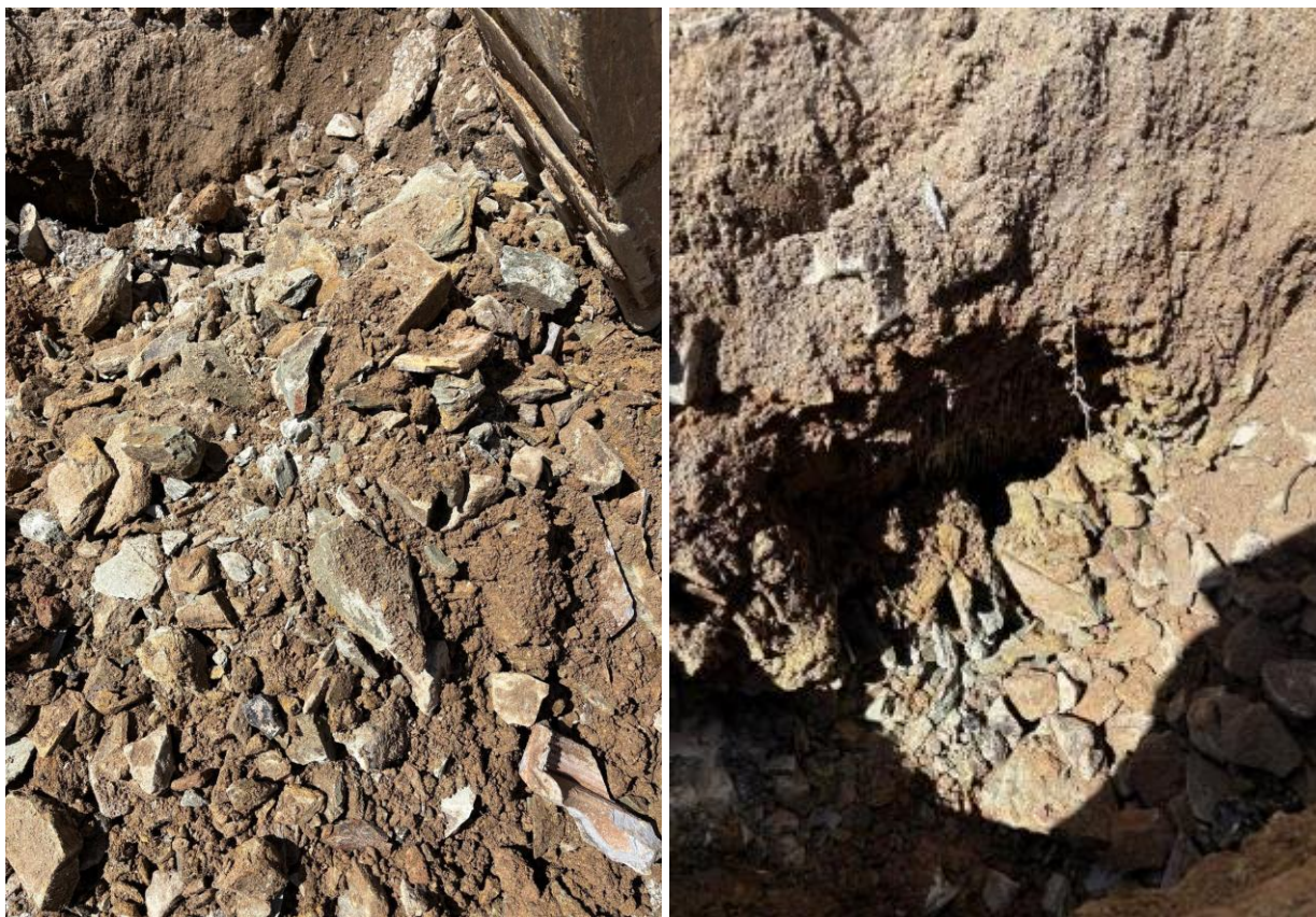
Figura 9-Material intersetado no horizonte de xisto – P05.
