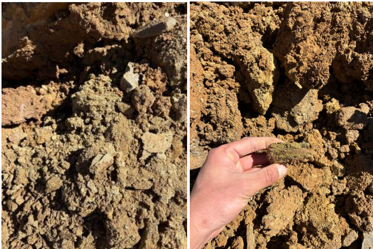
Figura 10-Material intersetado no horizonte de alteração de xisto grauvacóide – P06.
