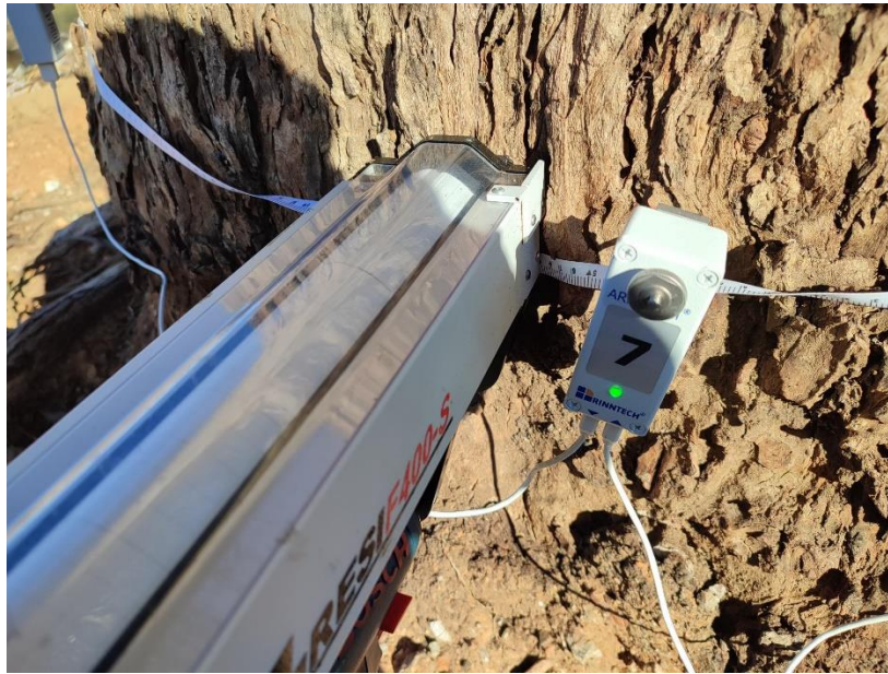
Figura 14 - Análise com recurso ao resistógrafo.
